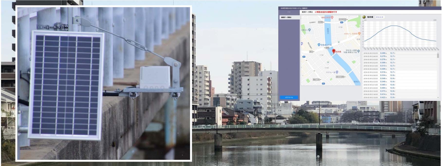
太陽光を電源とするワイヤレスの河川水位計を橋に設置し、通年で河川の水位をモニタリング
