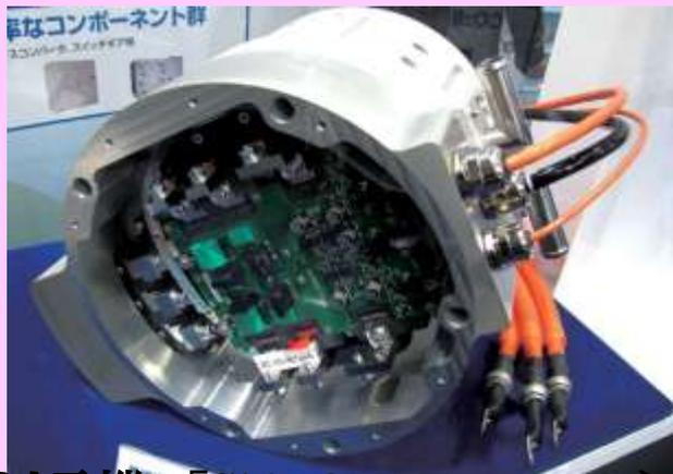
安川電機 「SiC-QMET」のモーターと制御回路部
