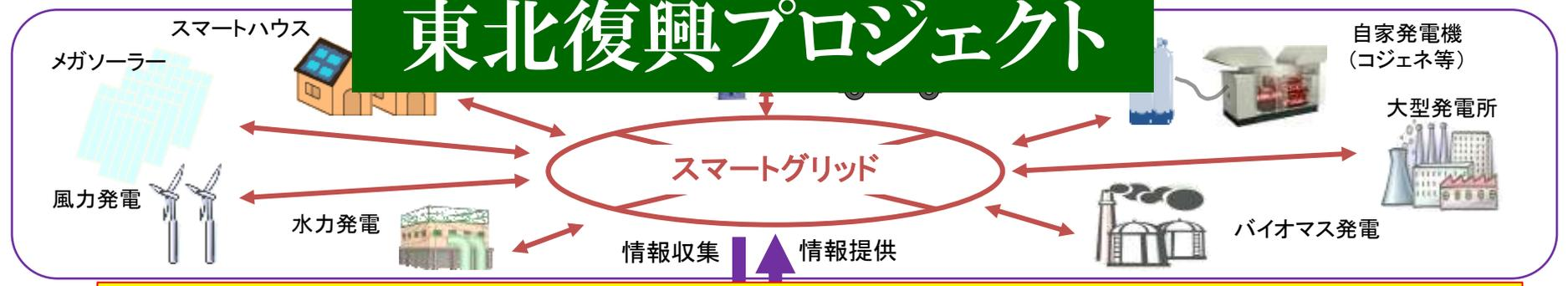
再生可能エネルギーを中心とし、人・車等のモビリティ（移動体）の視点を加えた都市の総合的なエネルギー管理システムの構築のための研究開発
