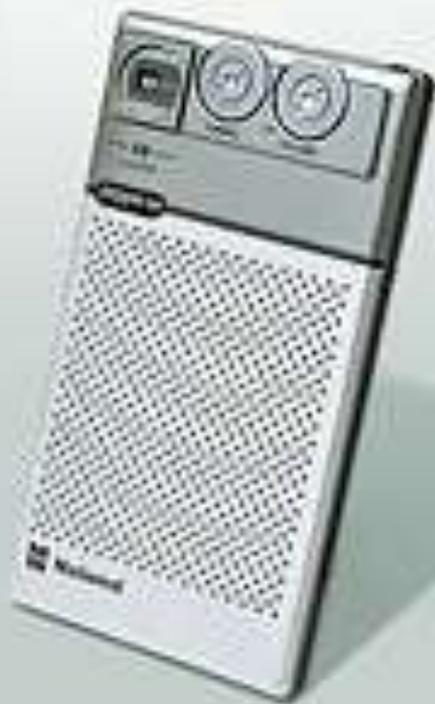
工法と部品の革新で世界最薄に成功した超薄型ラジオ1号。YM工法という新しいICチップ取付方法、薄型スピーカー、薄型バリコンの開発によって、厚さ12.7mmという画期的な薄さを実現したラジオ。、「軽薄短小」で付加価値を創造する商品デザインの先駆けとなった。
