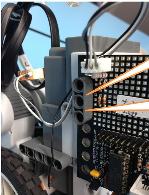
パワーメータの穴にNXTの接続部品を取り付け、そこにかぶせるように3穴部品を取り付けています
